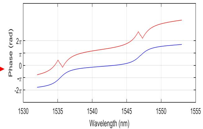
$t_1 > \alpha^2 t_2$  : over coupling
